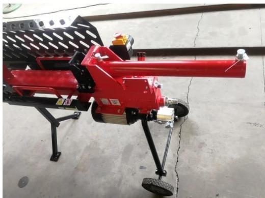
2. Kiinnitä kahden pääöljyletkun toinen pää sylinterin alapuolella olevaan venttiiliin, asenna hydrauliventtiili.
