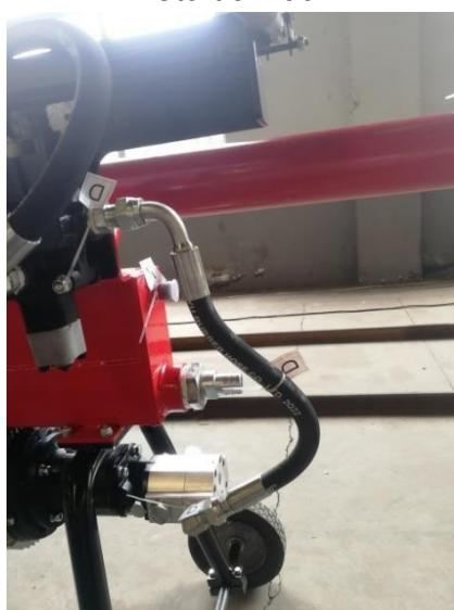
7. Liitä hydrauliventtiiliin paluuöljyaukko ja säiliön paluuöljyportti letkulla K.
